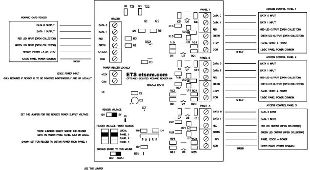
USE THIS JUMPER TO GROUND BOARD AND SYSTEM TO LOCAL EARTH GROUND FOR MPROVED LIGHTNING PROTECTION
